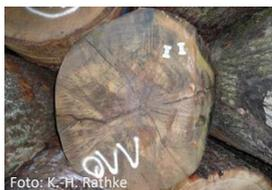
14 Bei einer **Ringschäle** handelt es sich um einen Riss, der dem Verlauf eines Jahrrings folgt und sich auf der Stirnfläche zeigt. Gemessen wird der Durchmesser A jenes Kreises, in dem der Ringriss als Bogen auftritt, ausgedrückt als Bruchteil des Durchmessers (D, ohne Rinde) der Stirnfläche.
