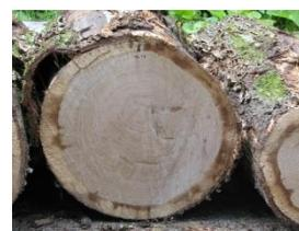
16 **Splintfäule** ist zulässig, ist jedoch über anteiligen Durchmesserabzug zu vergüten. An der Stirnfläche des schwächeren Endes ist die größte Ausdehnung der Splintfäule in radialer Richtung zu messen.
