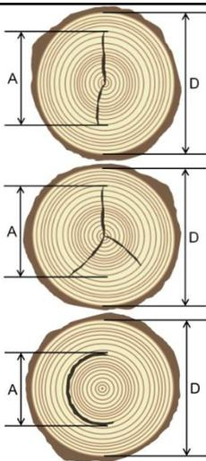
**13** Bei der **Ringschäle** handelt es sich um einen Riss, der dem Verlauf eines Jahrrings folgt und sich auf der Stirnfläche zeigt. Gemessen wird der Durchmesser A jenes Kreises, in dem der Ringriss als Bogen auftritt, ausgedrückt als Bruchteil des Durchmessers (D, ohne Rinde) der Stirnfläche.
