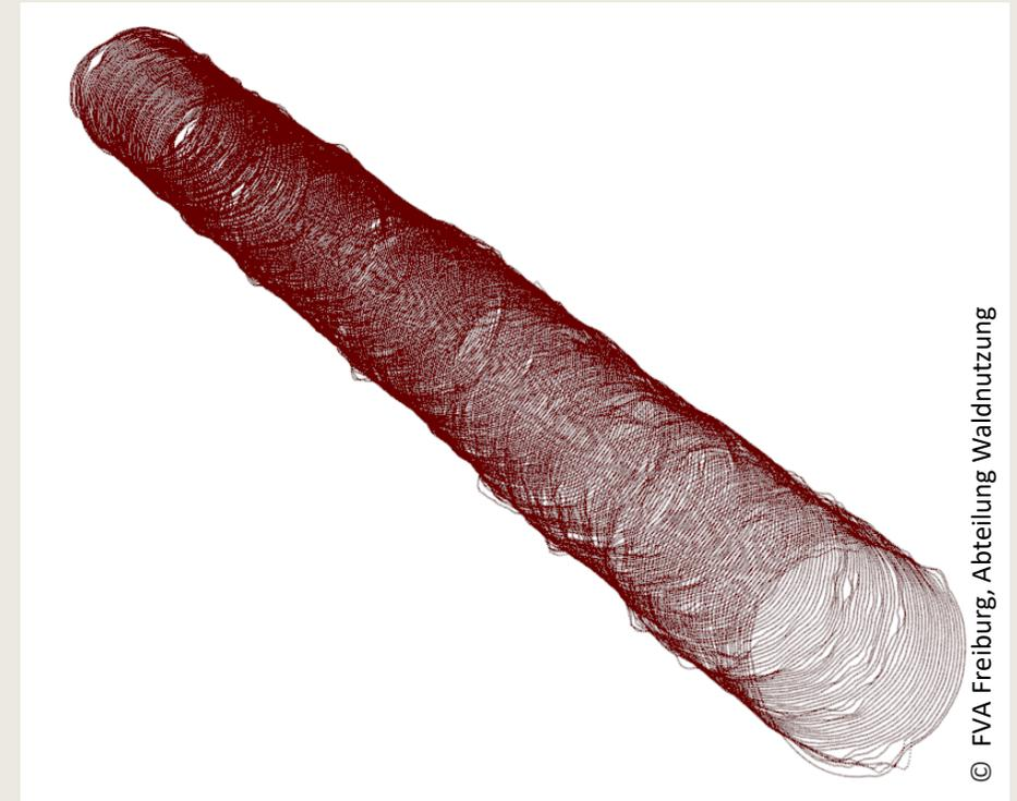
Ergebnis einer Laser-Kontur-Vermessung mittels einer Rundholzvermessungsanlage (FVA Freiburg)
