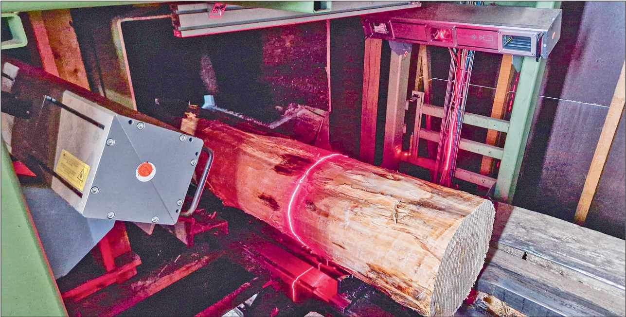
Vermessung eines Rundholzstammes mittels Lasertriangulation in einer geeichten Vermessungsanlage
